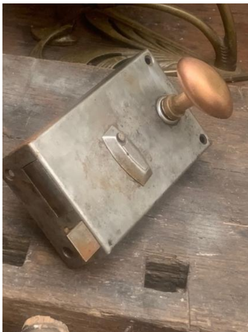
De gamla kammarlåsen är rejäla doningar. En ordentlig rengöring, putsning och ett par klickar fet gör dem ofta som nya igen.
