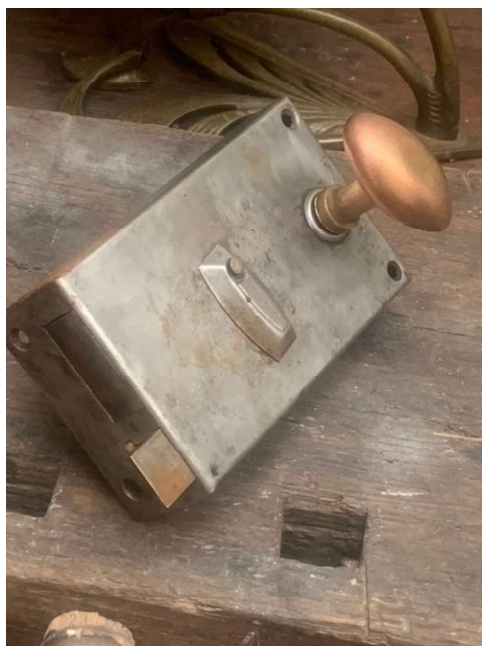
Les vieilles serrures à chambre sont des dispositifs solides. Un bon nettoyage, un polissage et quelques gouttes de graisse les rendent souvent comme neuves.
